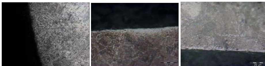
a) 24h b) 48 h c) 72h Slika 5. Metalografska analiza površine oksidnog sloja nakon ispitivanja vatrootpornosti, talina V1774, stanje TH1050, Kalling + Villela
