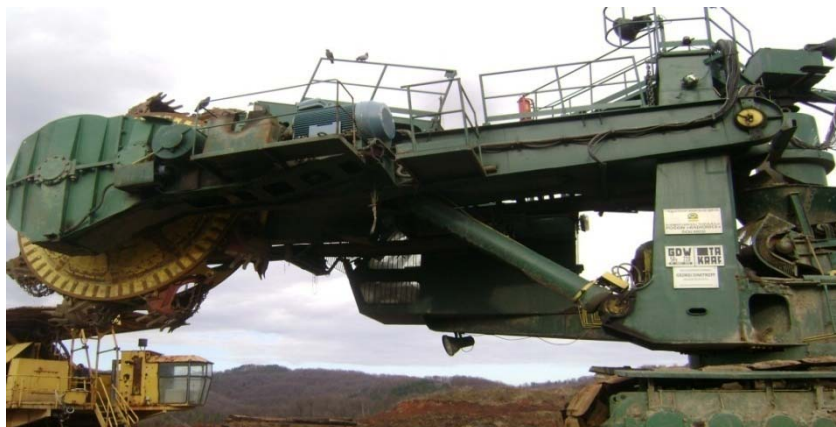
Slika 1: Pogon radnog točka sa starim motorom snage 160 kW
