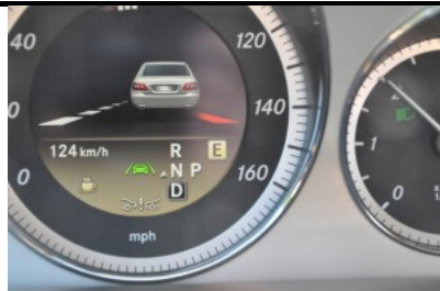
Slika 3. LDW sistem podrške vozaču koji daje upozorenje za napuštanje trake [14]
