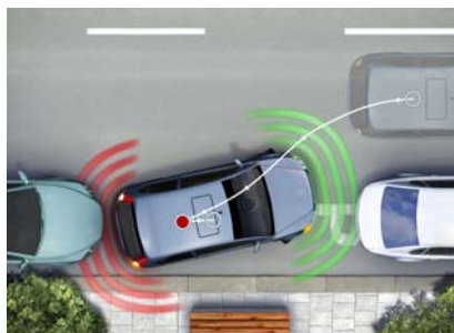
Slika 4. Princip funkcionisanja sistema za pomoć pri parkiranju [15]
