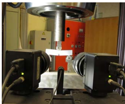
Slika 3. Ispitivanje SENB epruveta savijanjem u tri tačke stereometrijskim mjerenjem
